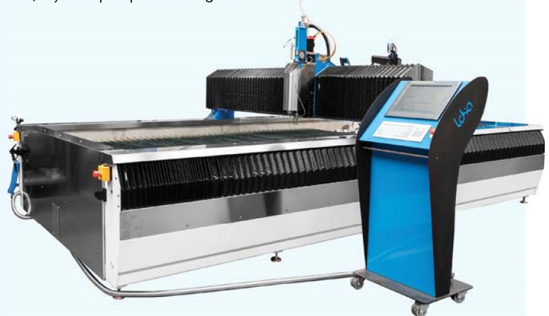
Le centre de découpe jet d'eau WJA II de LDSA est piloté par une CNC Fanuc.
