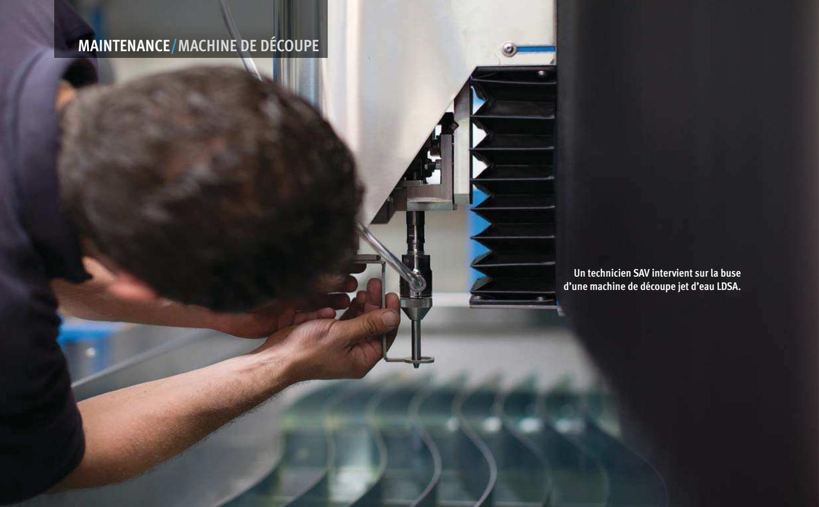
Un technicien SAV intervient sur la buse d'une machine de découpe jet d'eau LDSA.
